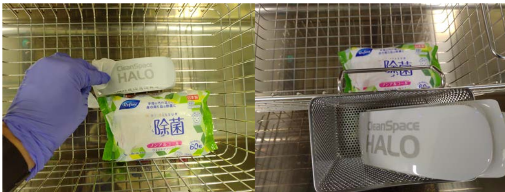
写真 5: HE フィルタの外表面を十分に消毒ワイプ 写真 6: 乾燥・紫外線照射用の金属小型トレイに移す。
