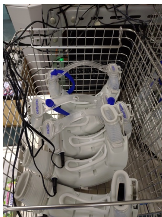
写真 16. 写真 17: 乾燥・紫外線照射が終了すれば、外に出して、充電用プラグを接続して、タイマー充電へ
